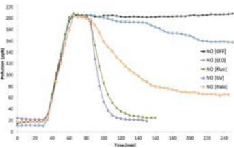
Le gaz pollué est injecté dans le réacteur à hauteur de 220 ppb de NO. Après remplissage du réacteur, la lumière est allumée, différents types d'illuminants pouvant être testés: fluorescence, UV, halogène, LED. La pollution à la sortie du réacteur est suivie en temps réel par l'analyseur. L'abattement, et donc, l'efficacité du procédé est caractérisé par la diminution relative du taux de NO. Les abattements suivants peuvent ainsi être observés:
