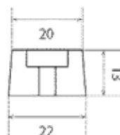
Cale pour bardage LOKI 13 x 22 mm Ø 20 mm
