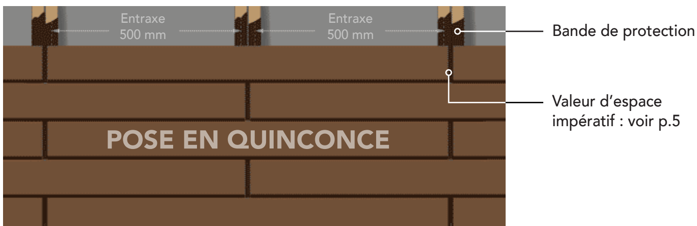
Fixation des lames à leur extrémité sur un tasseau = Stabilité
